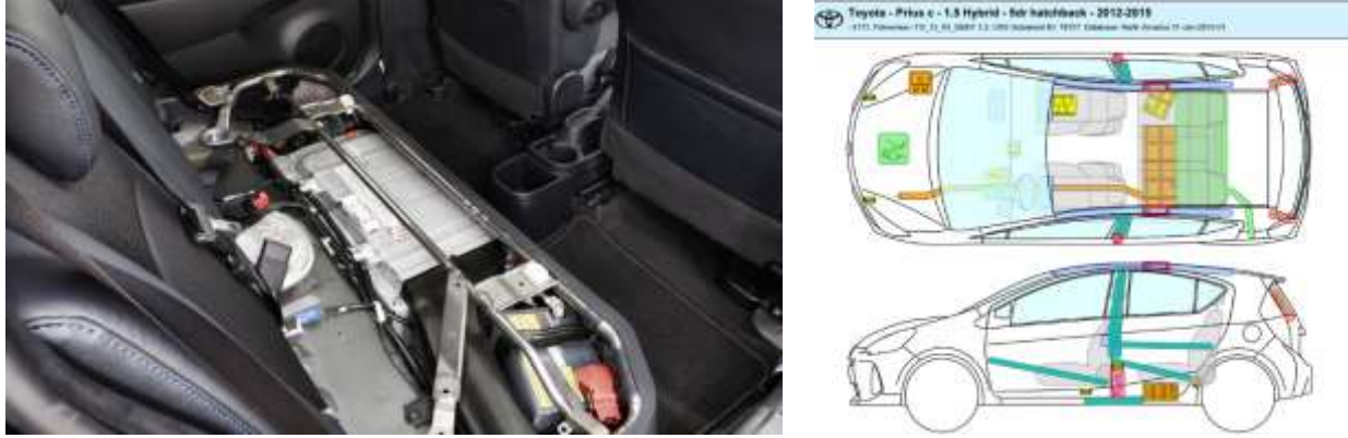
Resim 7- Toyota Yaris Hybrid’de arka koltuk altındaki 12 V akü(sağ alt) ve HSD pil sistemi 7
